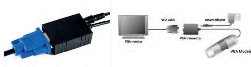
Des modèles en temps réel à haute vitesse qui se connectent directement à un écran VGA via un connecteur VGA (D-SUB). Il offre un taux d'images par seconde élevé qui va jusqu'à 60 ips à une résolution de 800x600 et il a une visibilité améliorée dans une faible lumière de manière à bien voir dans toutes les situations.
