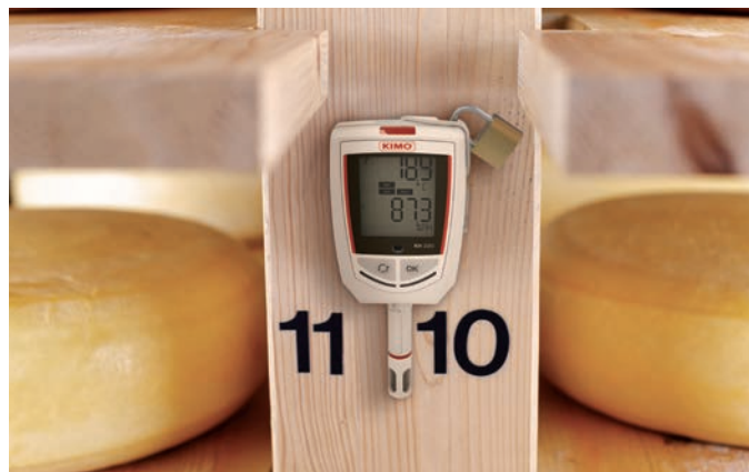
Contrôle en humidité relative et température en cave d'affinage, assuré par un KH 220 fixé sur platine de fixation et sécurisé par un cadenas dans le cadre d'une cartographie.
