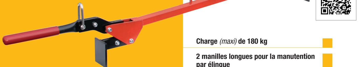
Matériel pro très robuste conçu pour une charge (*maxi*) de 180 kg. Commande de serrage par levage de la poignée (*manuel ou avec élingue*) et avec action directe sur la charge à soulever. Produit contrôlé en statique à 1,5 fois sa charge maximum. Livré avec 2 manilles longues pour la manutention par élingue. Long. 1,80 m (*1,20 m avec poignées refermées*), haut. 0,20 m. Livré avec notice d'utilisation.
