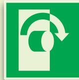
Tourner dans le sens des aiguilles d'une montre pour ouvrir
