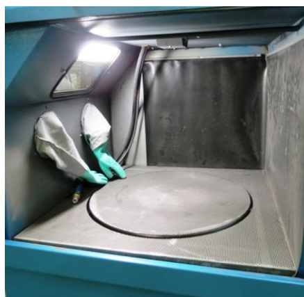
Option: Plateau tournant manuel intégré à la grille
