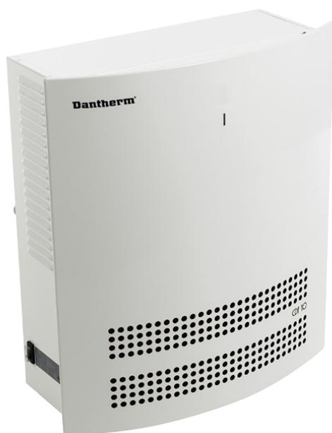
Le déshumidificateur fonctionne selon le principe de la condensation frigorifique. Un ventilateur aspire l'air ambiant et le dirige sur l'évaporateur. L'air est refroidi et la vapeur d'eau ainsi condensée est recueillie par le réceptacle et est évacuée. L'air maintenant sec passe sur le condenseur ou il est réchauffé avant d'être réintroduit dans le local – lors du passage de l'air dans le déshumidificateur, la température augmente d'environ de 5 °C.
