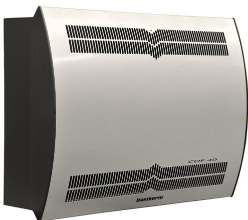
Le CDF 40 est un déshumidificateur mural éconergétique et silencieux. Il fonctionne selon le principe de la condensation frigorifique. Un ventilateur aspire l'air ambiant et le dirige sur l'évaporateur. L'air est refroidi et la vapeur d'eau ainsi condensée et évacuée. L'air sec passe ensuite sur le condenseur où il est réchauffé avant d'être réintroduit dans le local – lors du passage de l'air dans le déshumidificateur, la température de l'air augmente d'environ 5°C.
