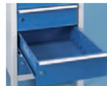
Les parois latérales des tiroirs sont crantées au pas de 75 mm pour l'apport de séparateurs. Les serrures d'un même établi s'ouvrent et se ferment à l'aide d'une seule et même clé. 80% d'extension, charge admise de 60 kg.
