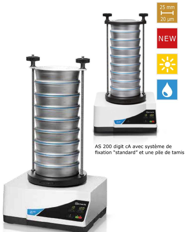
AS 200 digit cA avec système de fixation "standard" et une pile de tamis
