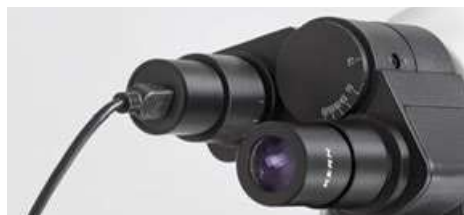
Caméra oculaire fixée au tube oculaire
