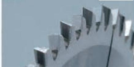
Denture à pointes biseautées alternativement et à forme trapézoïdale qui la rend plus efficace en transversale dans la fibre de bois. Usage dans le bois en coupe de précision
