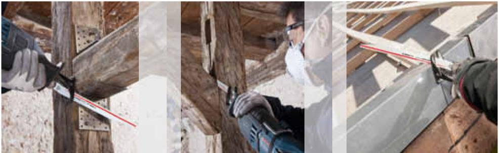
La denture progressive est idéale pour le sciage de poutres de bois épaisses avec éléments de fixation fins.
