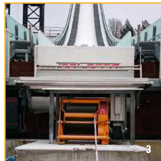
3. Tirage de poids utilisés pour tasser la neige sur un tremplin de saut à ski.
