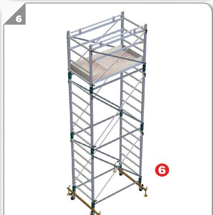
Pour le modèle ALUTOP 6,30 m, répéter les opérations 2 et 3. Stabiliser l'ensemble en plaçant les 4 grands stabilisateurs.
